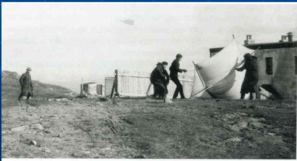
Marconi (a sinistra) e i suoi collaboratori alzano l'aquilone che sosterrà l'antenna a 120 m
