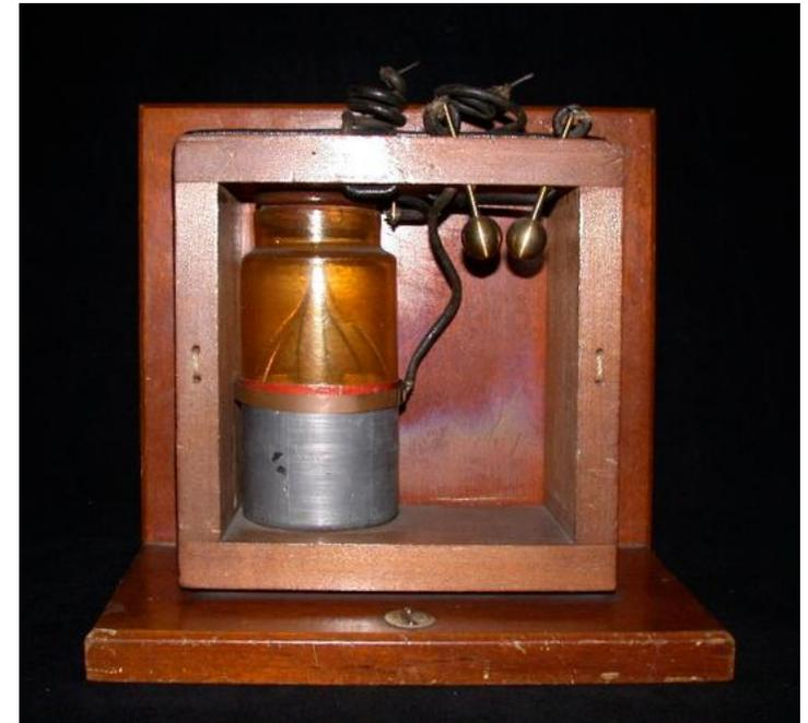
Marconi potenzia la ricezione del segnale con la realizzazione del detector magnetico che permette maggiore stabilità nella trasmissione a grandi distanze, il primo lo costruisce nel 1902 in modo artigianale in una *scatola di sigari* per utilizzarlo a bordo della Regia Nave “Carlo Alberto” che il Governo italiano gli mette a disposizione per i suoi esperimenti.
